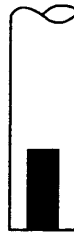
TIPO 2 Tapón de grafito poroso en el extremo del tubo de 2" x 2" x 1" de ancho.
