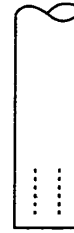
TIPO 1 Tubo de extremo cerrado con agujeros de 20-1/6" de diámetro en 2 1/2" del extremo.
